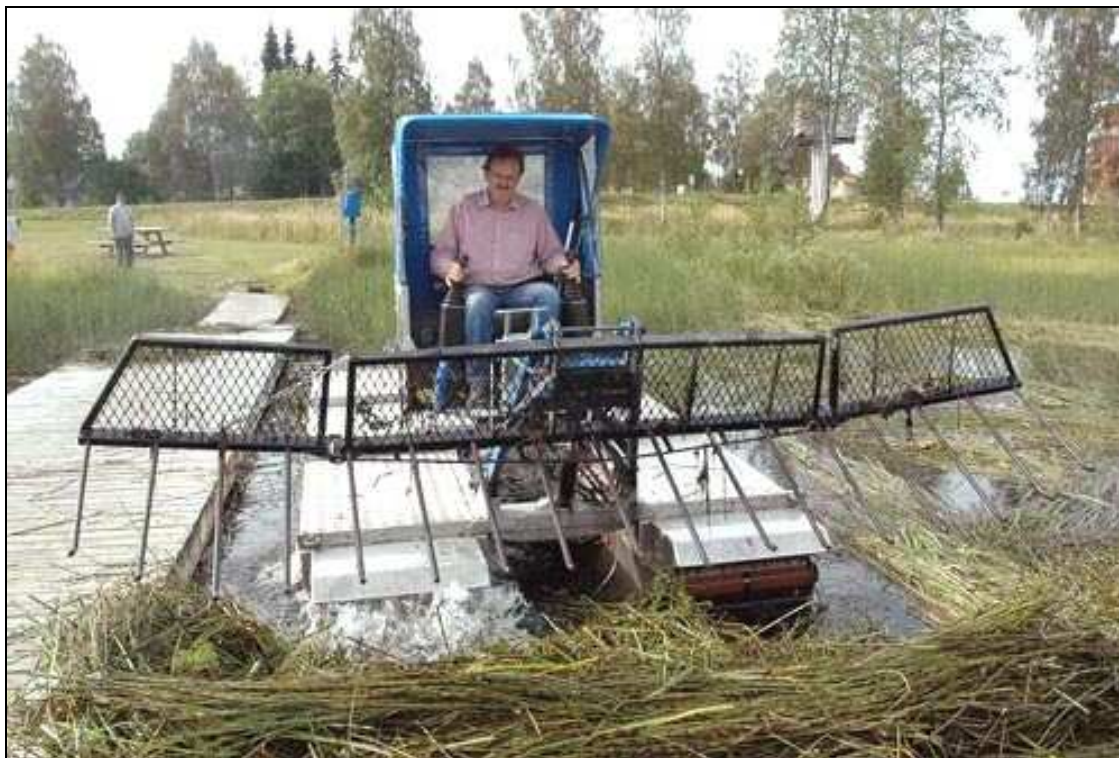
Fig. 15. Truxor 5000 med stranddrive. Kilde: Dorotea Mekaniske AB.
