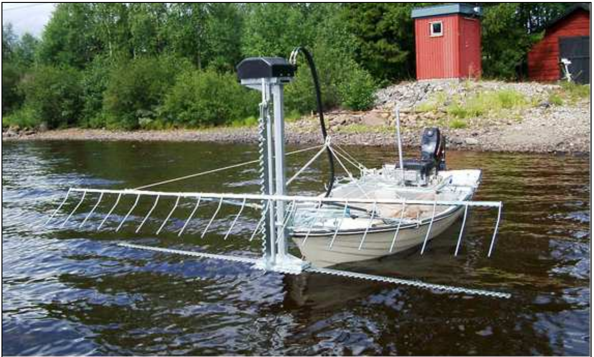
Figur 13. Dorocutter 3070 frontmontert på båt. Kilde: Dorotea Mekaniske AB.
