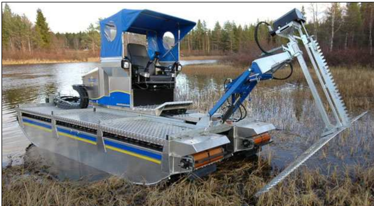
Figur 14. Truxor 5000. Skjæreaggregat på 4 meter bredde. Kilde: Dorotea Mekaniske AB.
